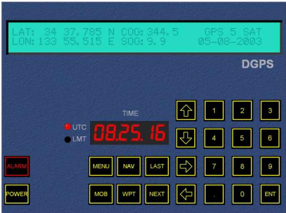
Rys. 1. Panel wskaźnika systemu DGPS w systemie Polaris symulatora nawigacyjno-manewrowego statku.
